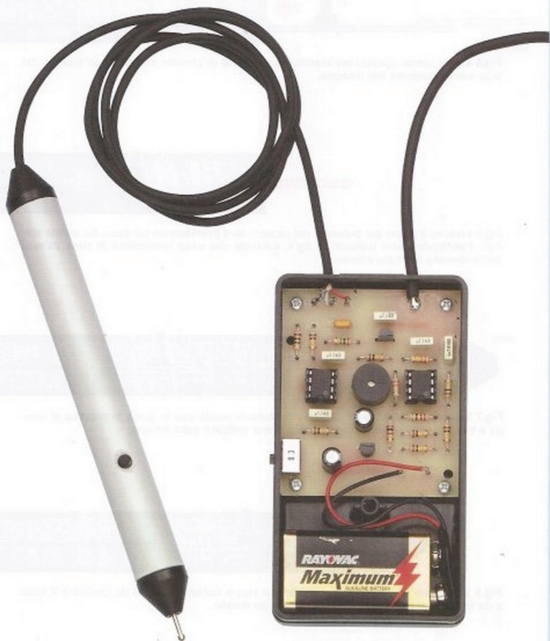
Fig.10 La foto di uno dei circuiti da noi realizzati per eseguire il collaudo. Sul retro del mobile plastico sono predisposti due fori: in uno di essi va inserito il cavo schermato che fa capo al puntale, saldandone accuratamente i tre terminali sulle apposite piazzole, nell'altro il cavo di collegamento che fa capo al contatto di massa, rappresentato da una piccola ventosa o da una pinza.
