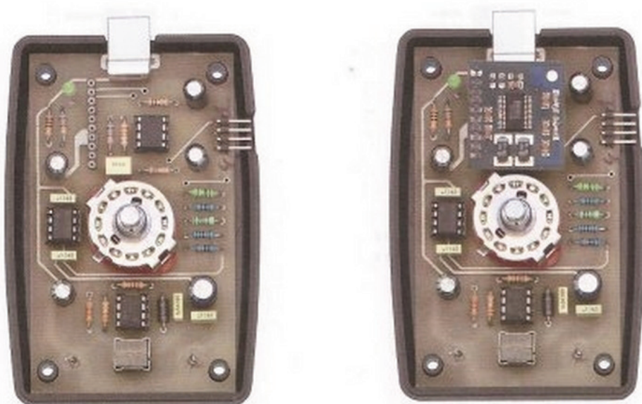
Fig.8 Una volta terminato il montaggio, il circuito andrà collocato sul fondo del mobile, facendo coincidere i fori sul circuito con gli appositi riscontri in plastica e avendo cura di fare fuoriuscire il connettore CONN.3 dalla fenditura a lato. A destra, il montaggio è completato dalla scheda KM1667 in SMD.
